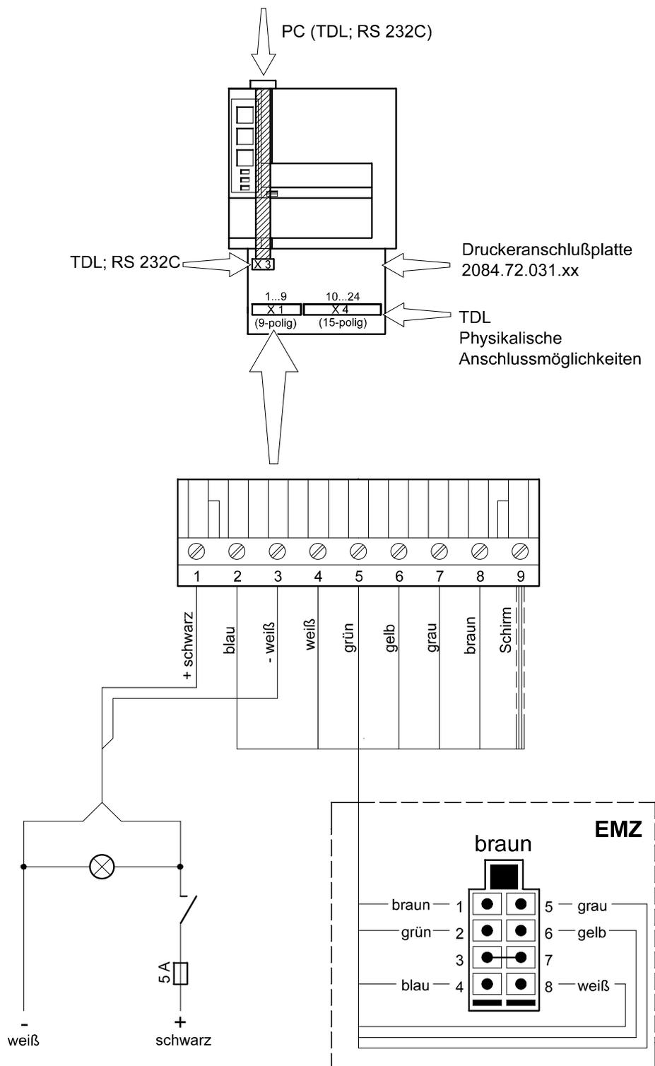
Abb 1-10: Anschlussplan für Druckervorschaltgerät 2084.72.031.xx
